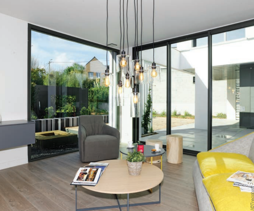
La transmission lumineuse des vitrages à contrôle solaire de la maison E-rose construite par Trecobat est réduite à 41 %. C'est toutefois compensé par le fort taux de surface vitrée : 25 %, contre 16,7 % sur une maison RT 2012.
