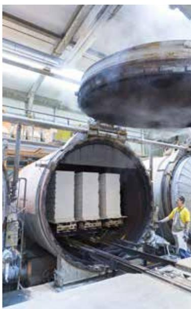
L'impressionnant dispositif autoclave, étape clef de la recette du béton cellulaire.
