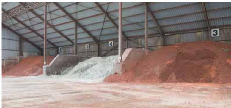
Les déchets à base minérale contiennent des éléments essentiels à la constitution du cru : oxydes de fer, alumines, silice et flux calcaïques ou gypsés.
