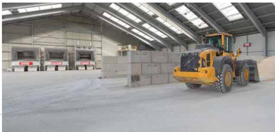
D'une capacité de 4 500 t, le hall assure aussi le stockage du calcaire et du gypse. Au fond se situent les trémies d'alimentation dédiées du broyeur.
