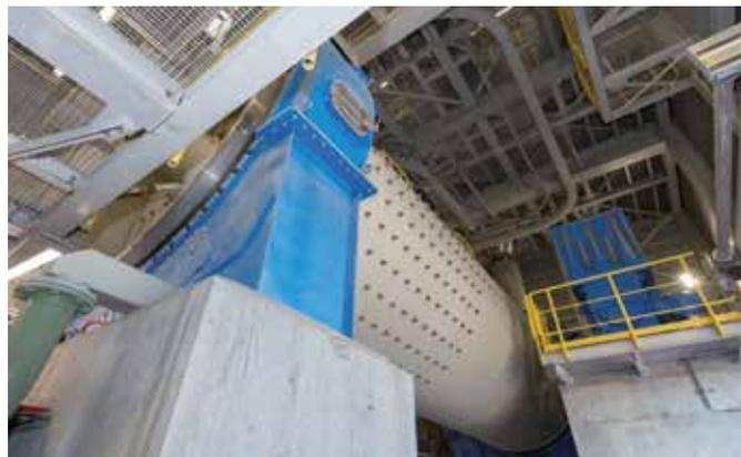
Cœur de l'usine, le broyeur à boulets InterCem offre un diamètre de 3,20 m pour 10 m de long. La puissance installée de l'équipement est de 1 300 kW.
