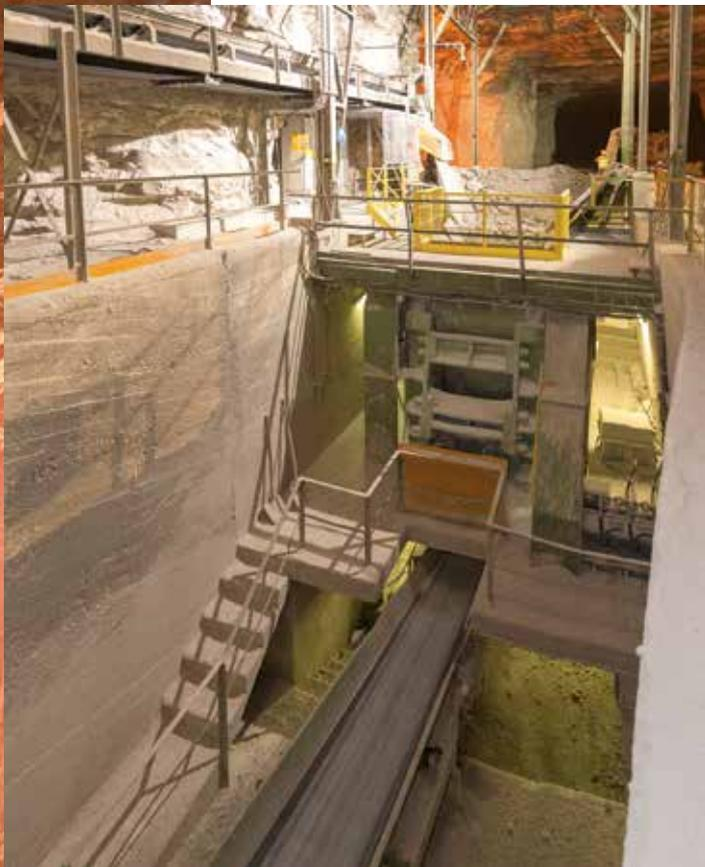
Le concasseur à mâchoires réduit les blocs calcaires 0/800 en trois coupures, dont une 20/150, qui servira à la production de la chaux.
