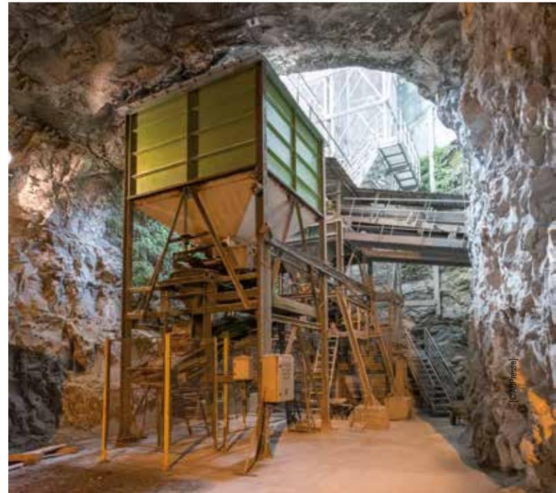
Au niveau de la trémie finale, le matériau est repris par un système d'élevateurs à godets, qui le transfert vers l'usine de production de la chaux.
