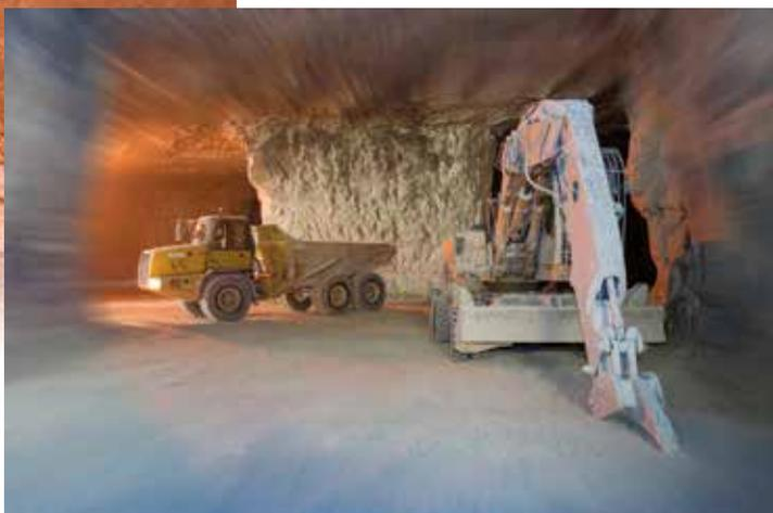
Après la purge du front de taille à l'aide d'une pelle hydraulique, la roche calcaire est transportée à l'aide de tombereaux articulés jusqu'au concasseur.
