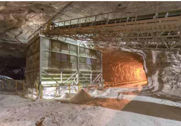
Trémies-tampons permettant le stockage provisoire des granulats 20/150, avant leur transfert en direction des unités de production de la chaux.
