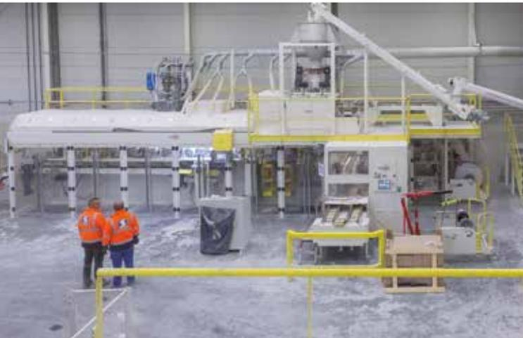
L'ensacheuse permet de remplir des poches en papier de 10 à 25 kg.
