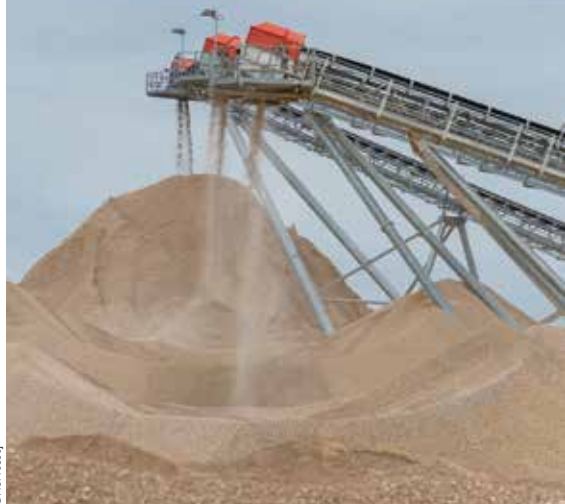
Sauterelles de mises en stocks des trois coupures produites sur le site de Bayel.
