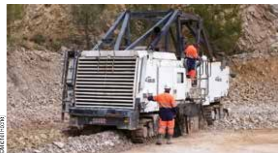
A Meyrargues, c'est une Wirtgen 2200 SM, qui crée une plate-forme pour Durance Granulats.
