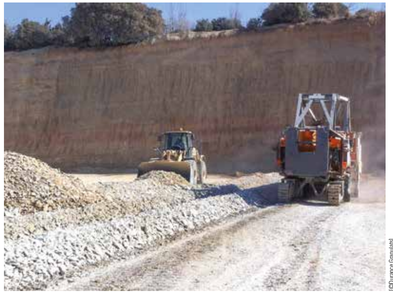
L'extraction des matériaux de carrière à l'aide de "surface miners" est possible jusqu'à une certaine dureté : 100 MPa, dit-on, mais aussi au-delà, si le matériau est fracturé.
