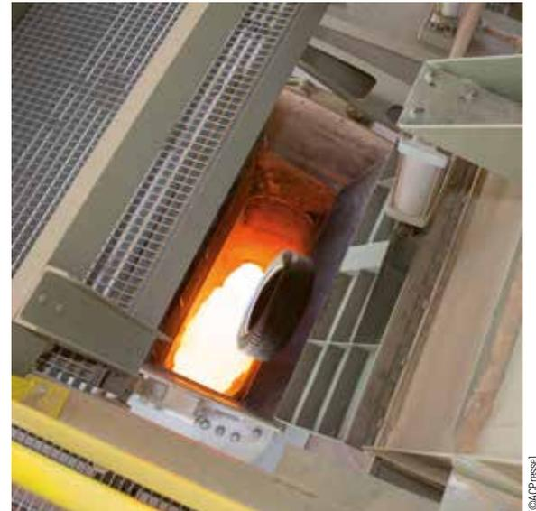
L'injection est aujourd'hui effectuée à raison d'un pneumatique par rotation. Mais la capacité d'absorption du four est de 3 pneumatiques à chaque tour.
