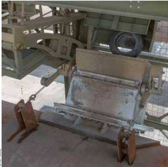
Une ouverture a été opérée dans le four et un sas à double clapet, installé.
