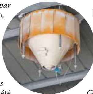
L'alimentation en sable du stock est opérée par des goulottes de type Venturi, construites et installées par la Smil.
