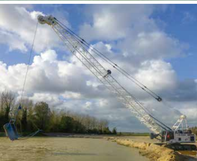
C'est une dragline Liebherr HS 8050 qui exploite le gisement d'Herre-les-Rue. Elle cherche le matériau jusqu'à 8 m de profondeur.
