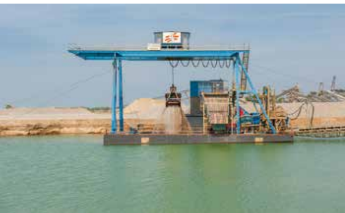
Oscar, une des deux dragues à bennes preneuses du Crotoy. Chacune produit 300 t/h en moyenne avec une benne de 6,5 m 3 .
