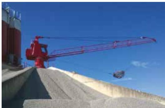
Pendant de nombreuses décennies, les stockages de granulats étaient organisés sous forme d'étoiles. Chaque case à granulats était séparée des autres par des murs en béton, en planches, le niveau de stockage étant géré par des draglines<sup>1</sup>, qui ramenaient les matériaux vers le centre du stockage. Un opérateur pilotait l'équipement depuis la cabine située en haut des murs et permettait ainsi les approvisionnements en continu. Et une gestion simplifiée des différentes cases.
