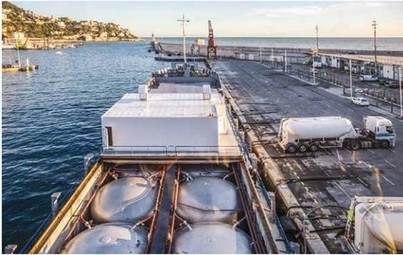
Le **Capo Cinto** est doté d'une capacité de 2 000 t, grâce à 14 cuves de 140 t chacune.
