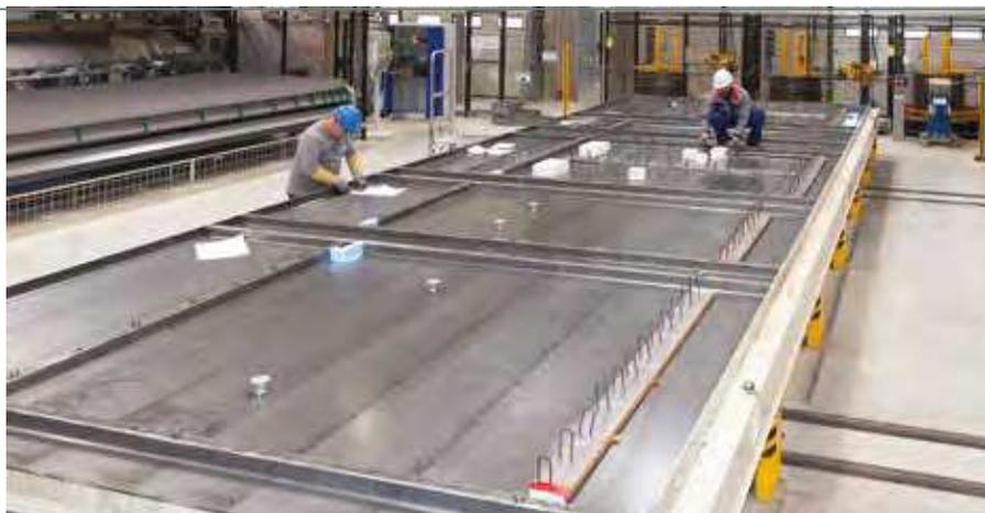
La préfabrication des Prémurs KP1 commence par la mise en place automatisée de règles aimantées de coffrage sur les tables. Les ajustements de coffrage sont réalisés de façon manuelle.
