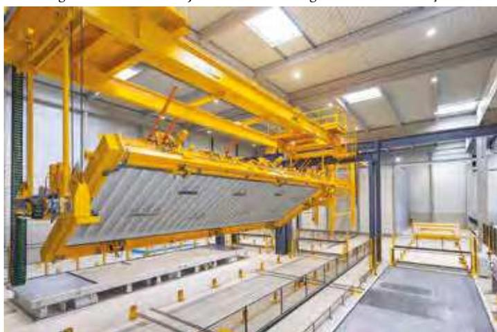
Opération de retournement pour permettre de poser la partie en béton durci sur la partie tout juste coulée (visible sur la table en bas et à gauche).
