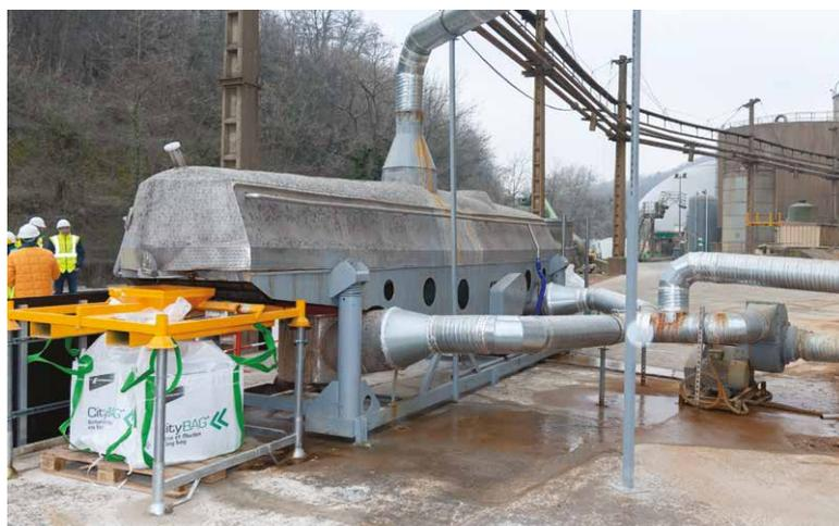
Sécheur à lit fluidisé installé sur le site de la cimenterie LafargeHolcim de Val d'Azergues (69).
