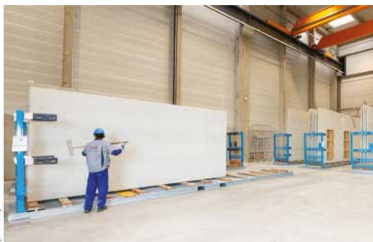
Racks de stockage en cours de remplissage et opération de vérification et de finition d'un Prémur KP1.
