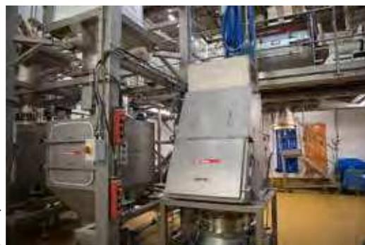
Gericke a développé une solution, permettant de vider les sacs, en limitant la poussière.
