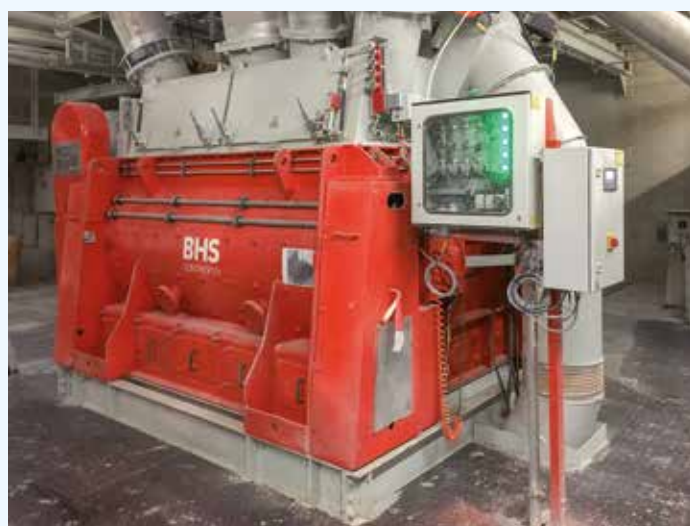
Le second malaxeur discontinu pour matériaux secs de type DMX 4900 S de BHS-Sonthofen tourne aujourd'hui au sein de l'usine Sud de Wopfung.
