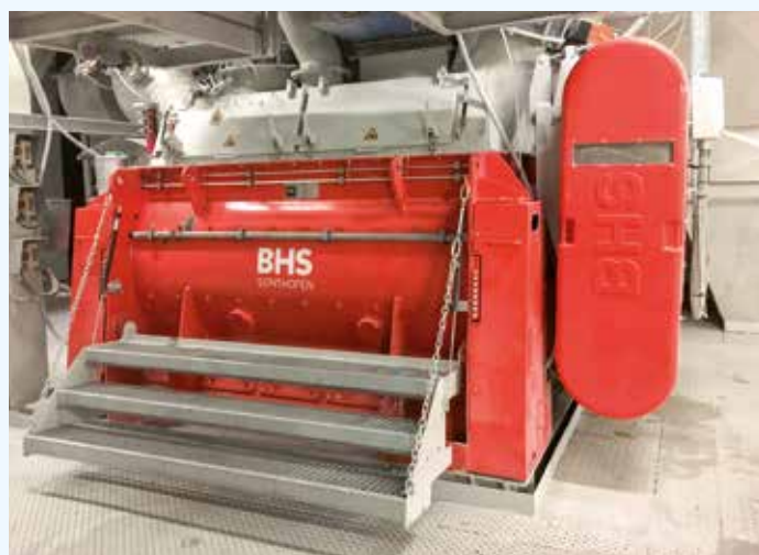
Baumit a fait installer son premier malaxeur discontinu pour matériaux secs de type DMX 4900 S de BHS-Sonthofen dans son usine Nord de Wopfung.
